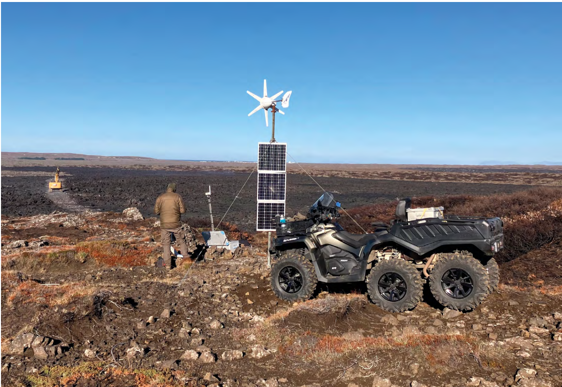
Obr. 8 Seismická pozorování na Islandu. Seismické stanice Geofyzikálního ústavu na poloostrově Reykjanes na jihovýchodě Islandu podstatně přispívají k okamžitému a velmi přesnému určení polohy, síly a charakteru zdejších zemětřesení, spojených s migrací magmatu. Stanice jsou napájeny obnovitelnou energií ze solárních panelů a větrných generátorů a o jejich údržbu pečují kolegyně a kolegové z týmu studujícího seismické vlny a zdroje a z týmu observatorního. V pozadí je patrný lávový proud vzniklý během výlevné erupce v srpnu 2024, který si vyžádal operativní přesun stanice, aby nebyla zalita lávou a byla zachována kontinuita monitoringu seismické aktivity. Foto: Archiv GFÚ AV ČR
