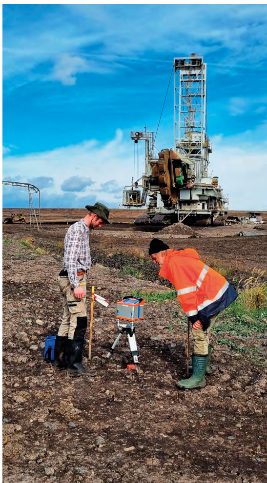
Obr. 6 Gravimetrické monitorování v hnědouhelném dole v severních Čechách. Cílem monitoringu bylo vysledovat režim podzemní vody v podloží těžné slaje. Pomocí gravimetrické metody lze sledovat změny hmot pod povrchem, což mohou být i přesuny podzemní vody ve zvodnělých vrstvách. V tomto případě byla gravimetrie doplněna sledováním poklesu povrchu opakovanou nivelací všech měřicích stanic. Analýza naměřených dat umožnila lokalizovat koridor průniku podzemní vody do podloží uhelné slaje, což umožnilo společnosti Severočeské doly, a. s., adekvátně přizpůsobit plán další těžby. Na obrázku provádějí gravimetrické měření na jednom z měřicích bodů Roman Beránek a Jan Mrlina z týmu užité a environmentální geofyziky. Foto: Archiv GFÚ AV ČR
